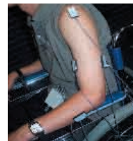
図2. 筋電の測定箇所
